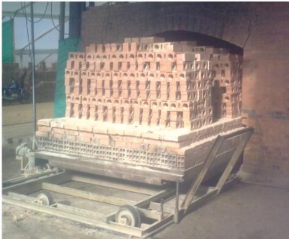
Salida vagoneta horno túnel de Granito de Oro - Archivo Granito de Oro
